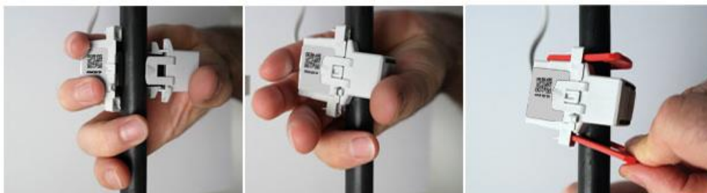
a) Instalace transformátoru KBR
